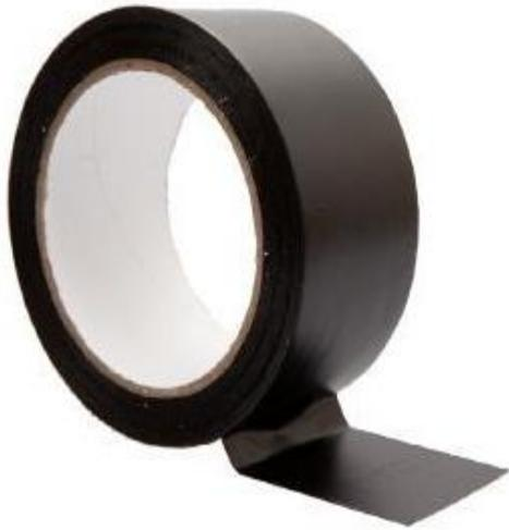
Primero enganche un trozo de cinta adhesiva de emisividad (al objeto a medir. Después de un rato, mida la temperatura del área con la cinta con la cámara termográfica y la emisividad ajustada a la de la cinta. La temperatura medida es el valor de referencia.
